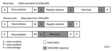
Fig. 23 - Send Byte/Receive Byte Protocol
